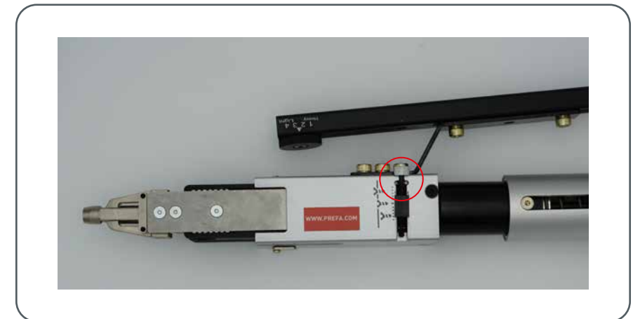
Abbildung/Illustration 3 · Einschraubtiefe einstellen
