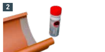
2 Klebefläche mit dem Schleifpapier anschleifen. Die Fläche mit dem PREFA Haftreiniger reinigen, und die Verdunstungszeit von 5 Minuten abwarten.
