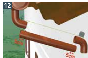
12 Ablaufrohr für Schwanhals ausmessen. Schwanhals an der Einhänglasche des Rinnenkessel mit Draht befestigen.
