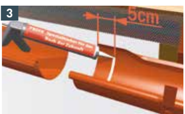
3 Mit PREFA Spezialkleber eine Kleberaube mit ca. 8 mm Dicke aufbringen.
