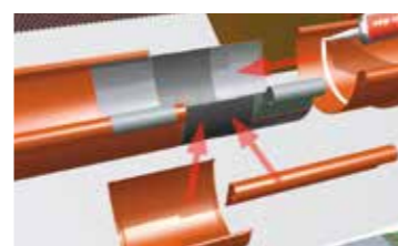
4 Mit PREFA Patentnieten 4 x 10mm im Kreuzstich vernieten - 6 Stk bei 25er Rinne, 8 Stk bei 28er und 33er Rinne, 10 Stk bei 40er Rinne, 20 Nieten pro Naht bei PREFA Saumrinne.
