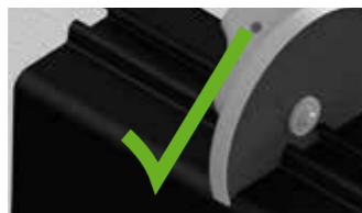
5 PREFA Quadratrohr immer an der Seite OHNE Einzug kürzen. Wird der Einzug (Verjüngung) abgeschnitten ist die Rohrverbindung durch ineinanderstecken nicht mehr möglich.
