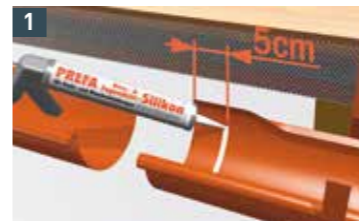
1 Auf das gereinigte und trockene Rinnenende 50mm vor dem Ende eine Raupe (ca. 8mm dick) PREFA Silikon aufbringen.
