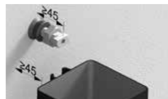
3 Abstand zwischen Wand und Quadratrohr von mind. 45 mm einhalten.
