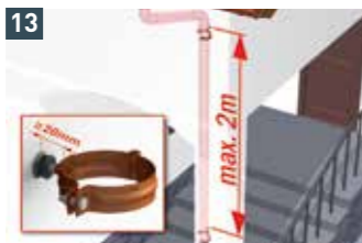
13 Rohrschellen an der Wand montieren. Je Einzelrohrstrang sind mindestens 2 Rohrschellen zu montieren
