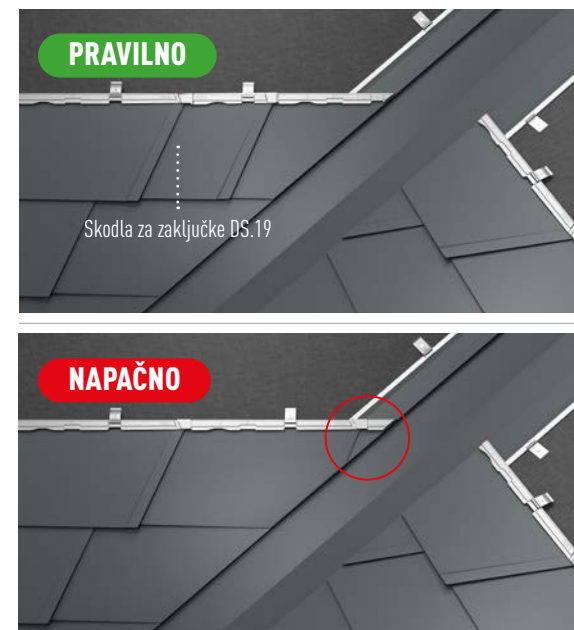
Slika 63 • Izdelava žlote – posebnost pri strešni skodli DS.19
