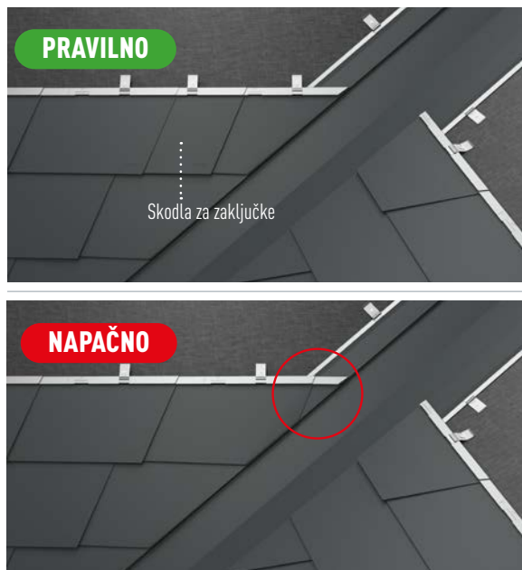
Slika 62 • Izdelava žlote – posebnost pri strešni skodli
