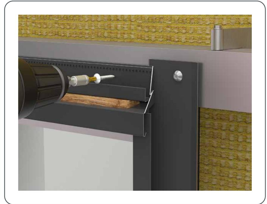
Slika 102 • Montaža perforirane zaslonke na okensko preklado
