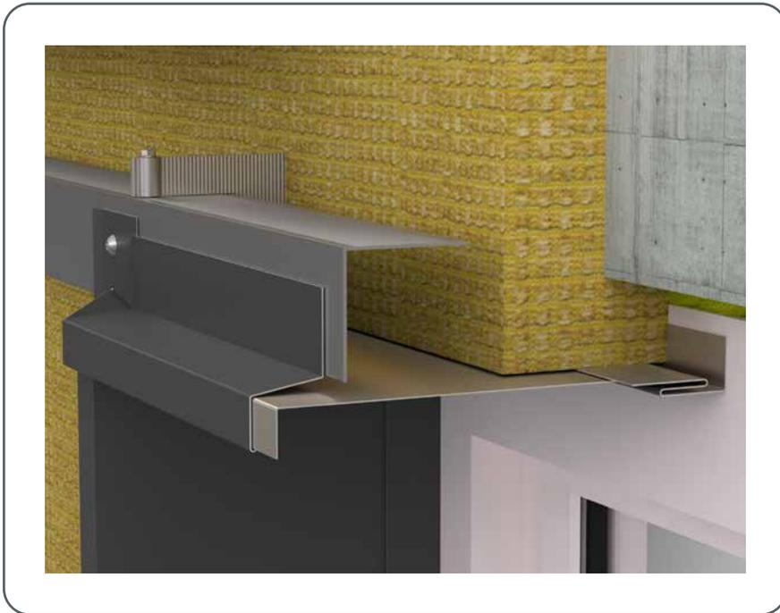
Slika 101 • Namestitev odkapnega profila okenske preklade
