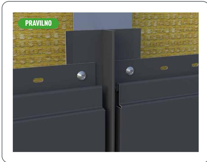
Slika 91 • Montaža z spojnim profilom
